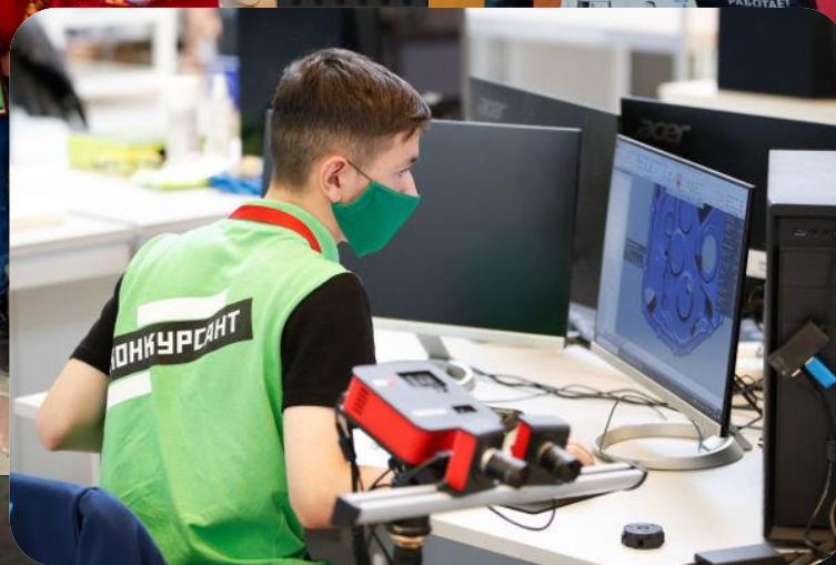
Сканирование и обработка модели с помощью сканера VT MINI
